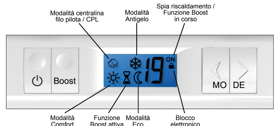
L'indicatore **ON** è visualizzato in ogni fase di riscaldamento dell'apparecchio (la temperatura ambiente è inferiore alla temperatura programmata richiesta al termostato).
