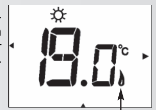
Heizanzeige des Heizkörpers
